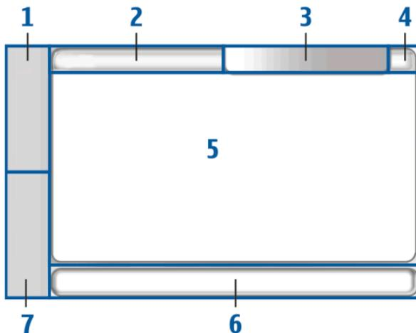
Сенсорный экран состоит из следующих элементов: навигатор задач (1), область заголовка приложения (2), область индикаторов состояния (3), кнопки свертывания и закрытия (4), область приложений (5), панель инструментов (6) и область выбора приложений (7).
